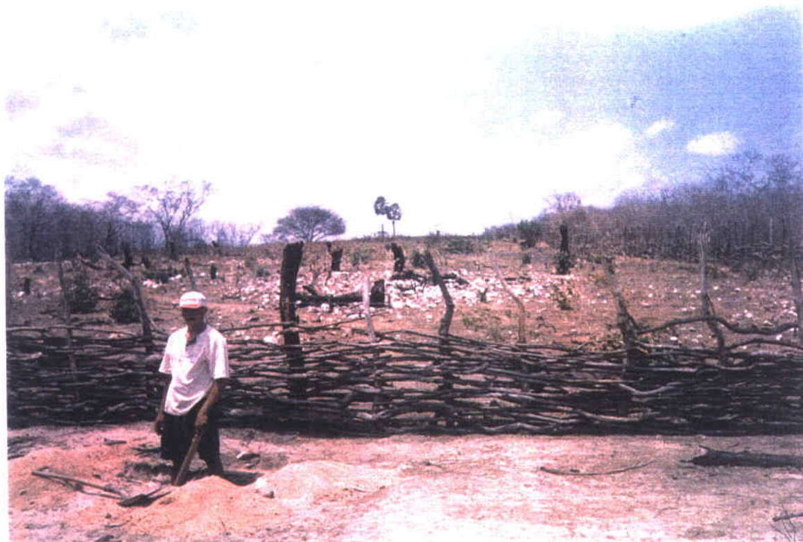
Foto 10 - Sondagem à pá/picareta em área de solo areno-argiloso com pedregulho na borda leste da bacia, a cerca de 400 metros da ombreira direita da barragem. Coord. UTM: 423.752; 9.629.342
