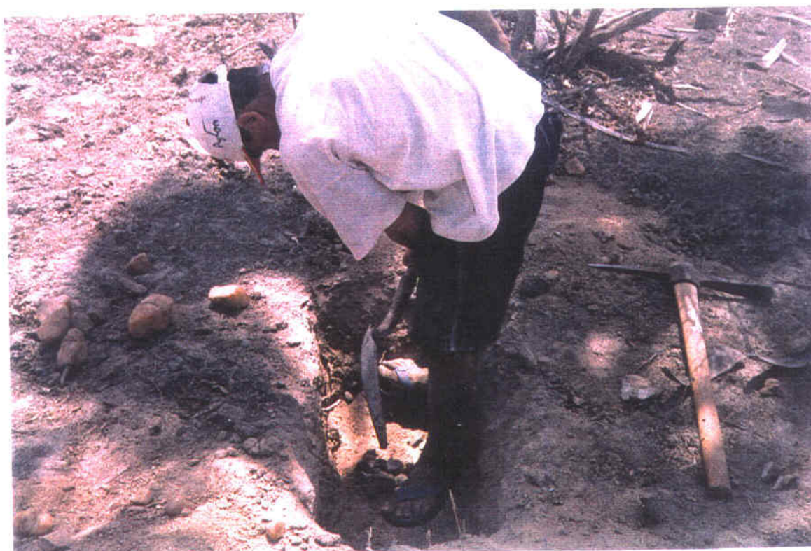
Foto 11 - Sondagem à pá/picareta em grande mancha de solo na área da bacia a cerca de 400 metros do eixo da barragem. Coord. UTM: 423.481; 9.629.067.
